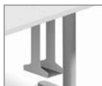
Suport metàl·lica ancorat al travesser
